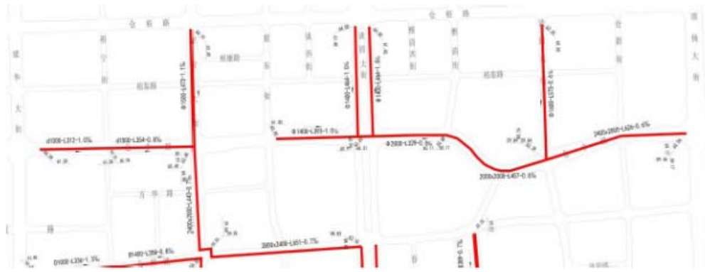
图 2-8 建华大街-复兴大街雨水管道布置图
